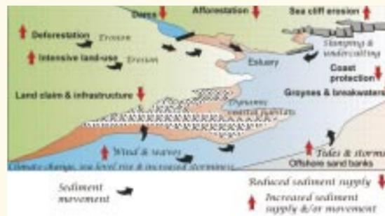
Schématisme du concept de "cellule sédimentaire côtière" (en anglais). Les flèches ascendantes indiquent les "sources" de sédiments (falaises, fleuves, basins versants, bancs de sables, etc.). Les flèches descendantes indiquent les "puits" de sédiments (barrages, ouvrages de protection). Le transport sédimentaire est indiqué par les flèches noires.
