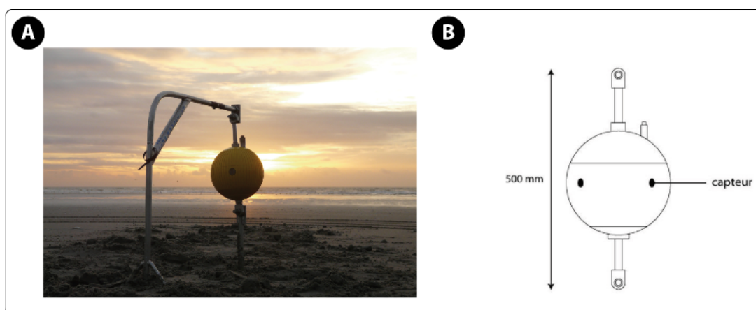
Fig. II-3: A) Photographie d'un S4 ADW déployé sur l'estran. B) Schéma technique d'un S4 ADW.
