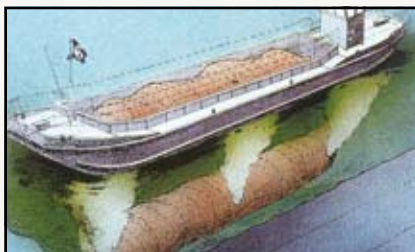
Système TenCate Geocontainer® largué par une barge spéciale s'ouvrant au milieu.
