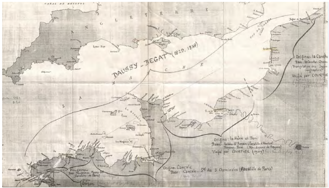
FIGURE 2.2 – Système géodésique utilisé au 19ème siècle par les ingénieurs hydrographes en Manche et Mer du Nord, les Hauts-de-France appartenaient au système de la Canche (issue des Archives du Shom)
