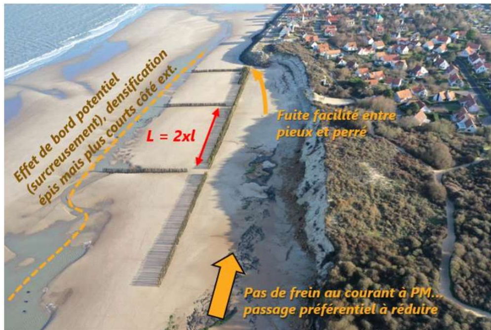
Figure 53 : Analyse du dispositif pieux bois existant
