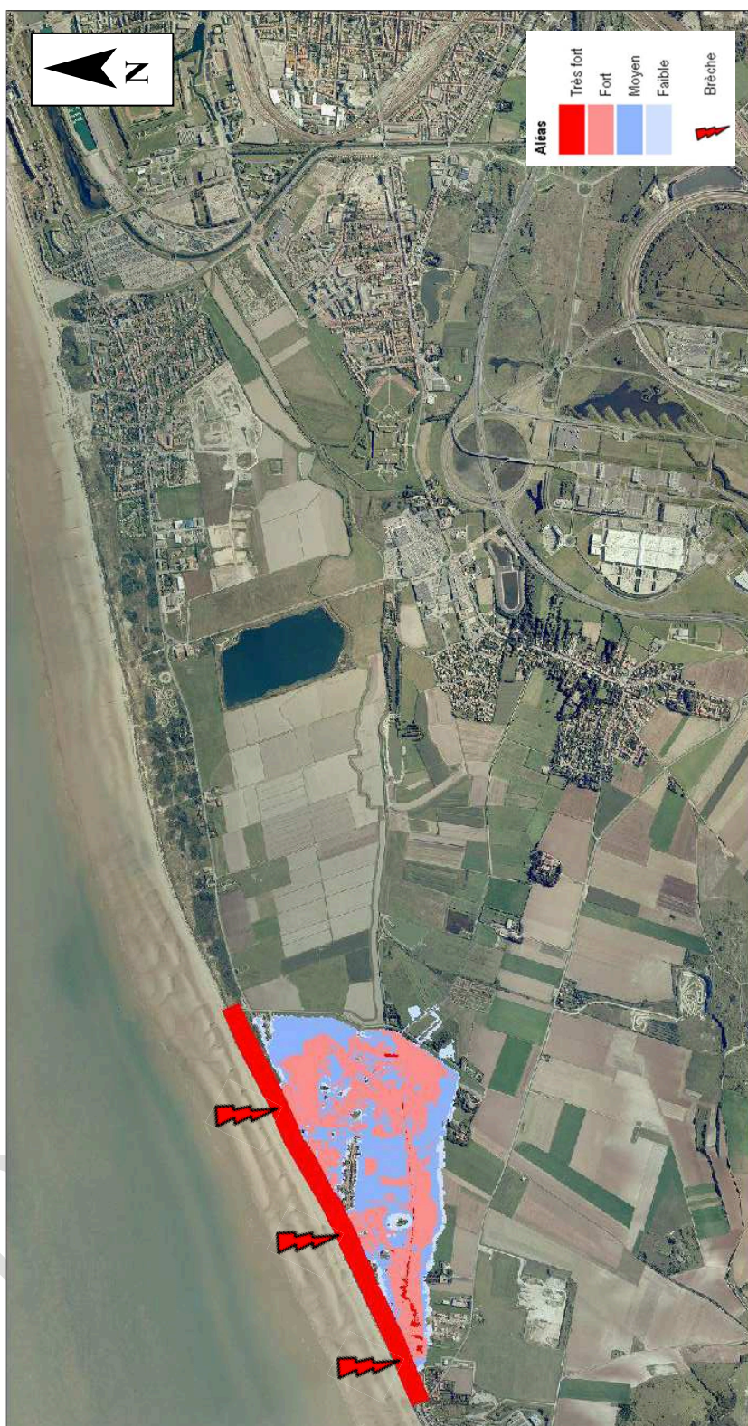
Figure 4-88 : Cartographie de l'aléa submersion modélisé pour un événement centennal et une brèche de la digue de 15 mètres
