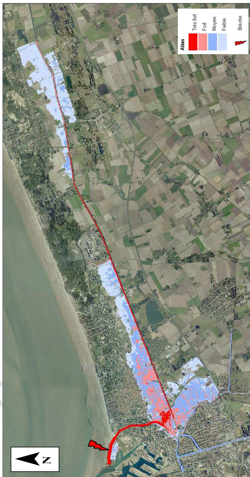
Figure 4-79 : Cartographie de l'aléa submersion modélisé pour un événement centennal et une brèche de la digue de 50 mètres
