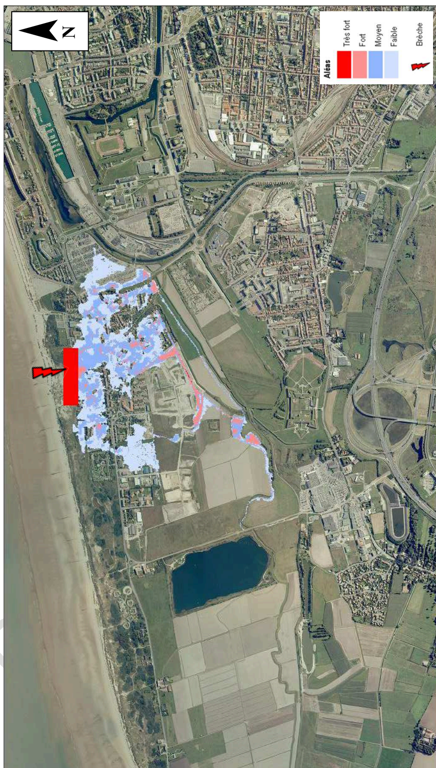
Figure 4-84 : Cartographie de l'aléa submersion modélisé pour un événement centennal et une brèche du cordon dunaire de 30 mètres
